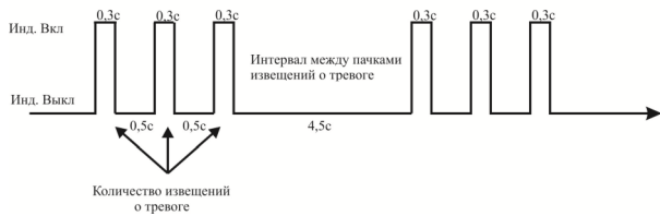
Рис. 1 Режим работы светодиодного индикатора
